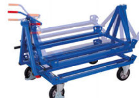
Żądaną pozycję uzyskuje się przez przechylenie uchwytu, uniesienie uchwytu powoduje zablokowanie platformy
