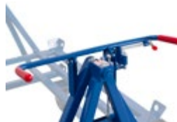
lösen der Grundstellung durch Herunterdrücken des Bügels
