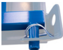
Zawlecзка zabezpieczająca ramę na wózku
