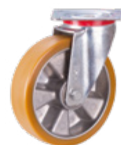
Koła poliuretanowe 92° Shore A nośność 2000 kg
